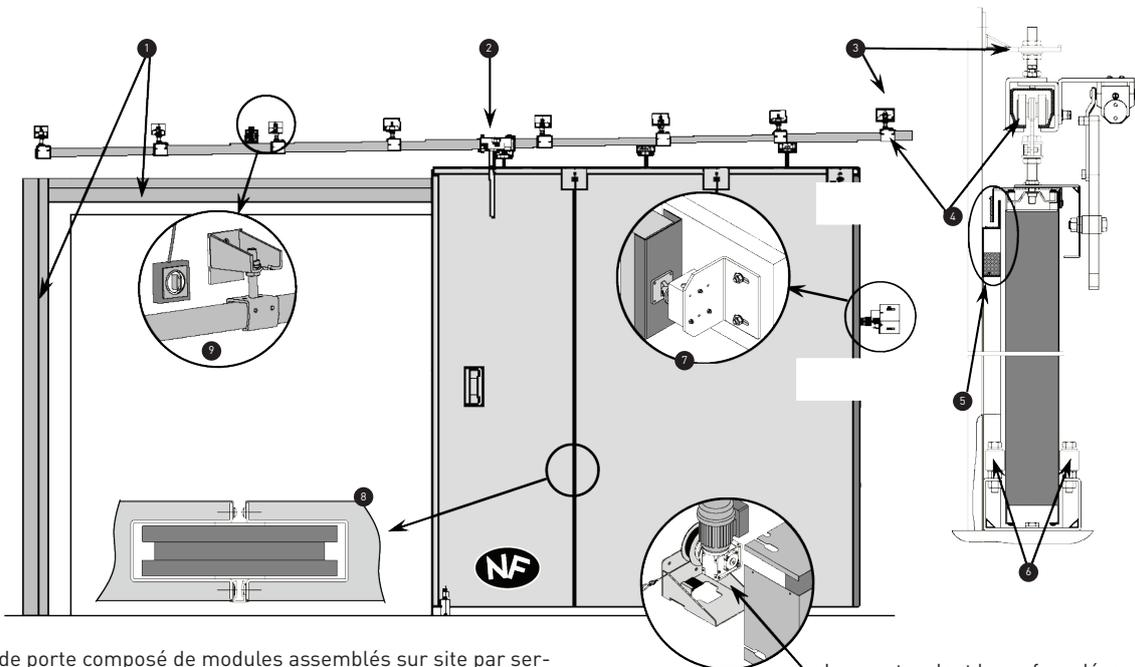
Tablier de porte composé de modules assemblés sur site par serrage haut et bas avec languettes coupe-feu et joints intumescents
